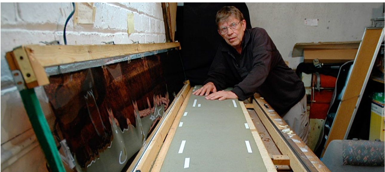
Michael Westmoreland an seinem Kontaktkopiergerät. Die Lampe mit Farb-Korrekturfiltern bewegt sich auf den seitlichen Schienen.
